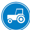
F11 Verplicht gebruik passeerbaan of passeerstrook (rijbaan of -strook om ingehaald te kunnen worden), uitsluitend bestemd voor motorvoertuigen die niet sneller kunnen of mogen rijden dan 25 km/h
